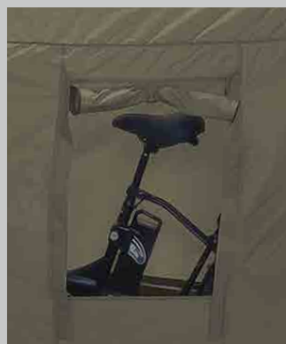
テントを被せたままバッテリー を取り出せる”取り出し窓”
